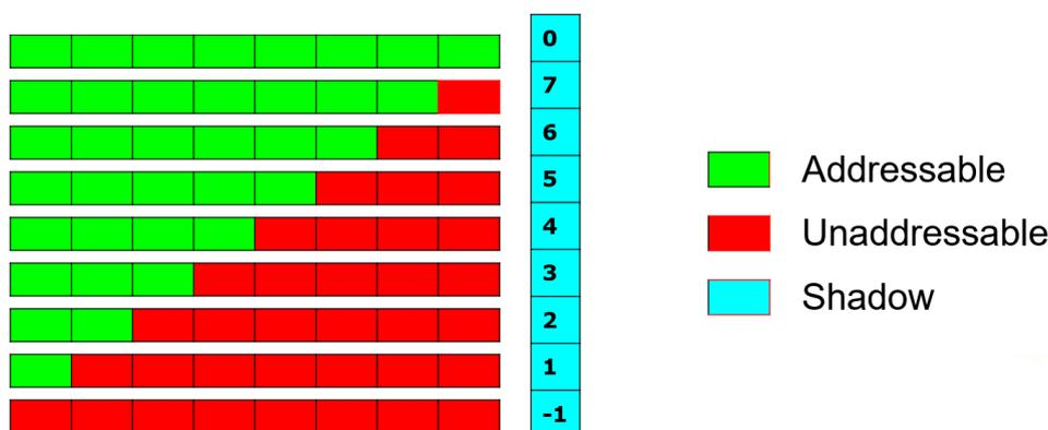
Abbildung 4.1: Codierung der Werte im Shadow Memory [39, Aus Folien d. Präsentation]
