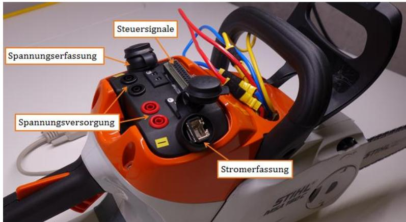
Abbildung 3-6: Veränderungen an der MSA 160 C – Gehäuse
